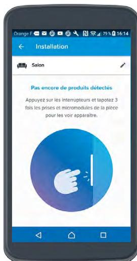
7-Appuyez sur les interrupteurs ou tapotez sur les prises connectées et les micromodules installés dans la pièce.
